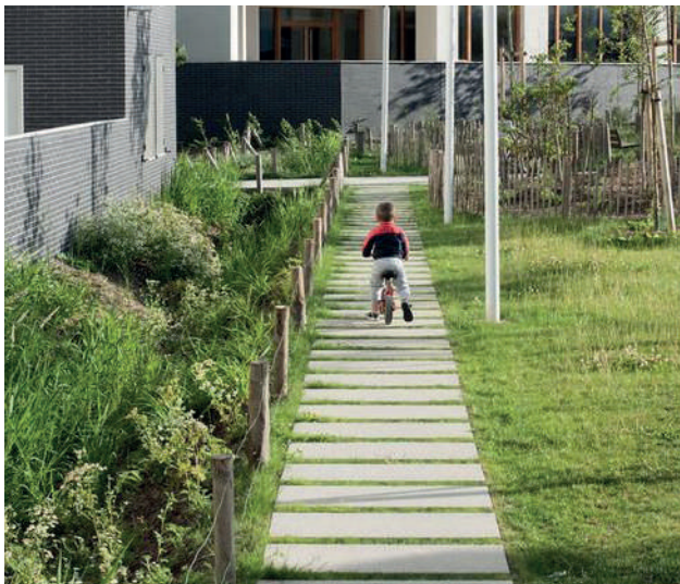
Noue et matériaux perméables - PARXYS
