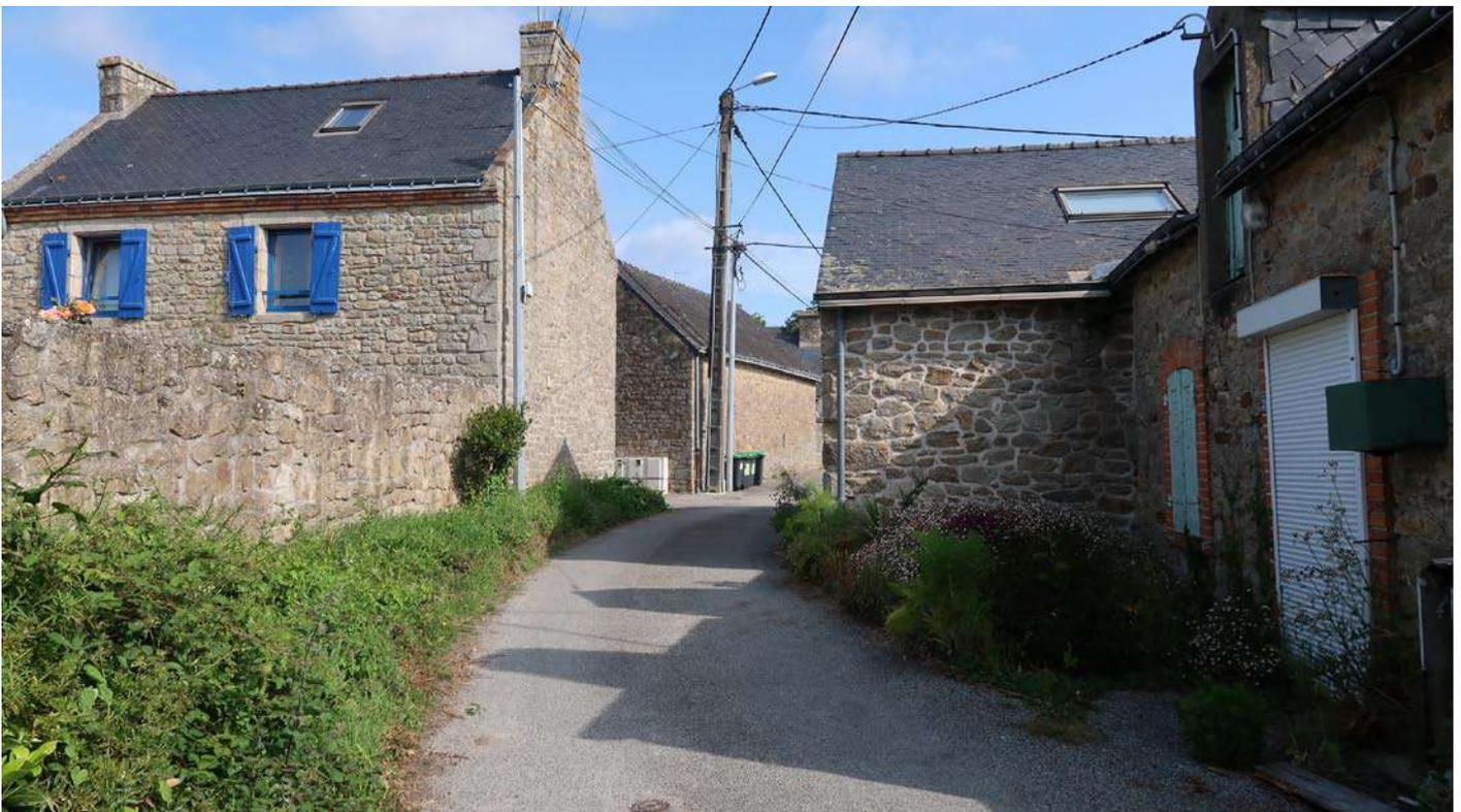
Le traitement traditionnel des voies dans les villages (sol stabilisé, abords enherbés) était favorable à l'infiltration des eaux pluviales, il s'agit d'un mode d'aménagement qui reste intéressant pour les nouveaux quartiers.
