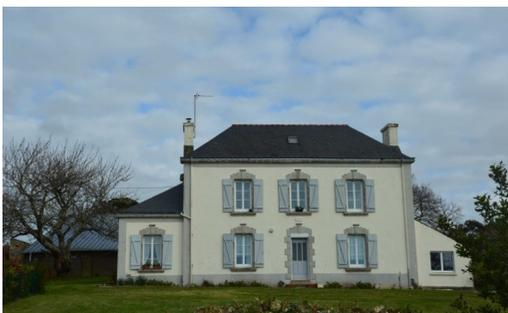
Les fenêtres sont verticales avec des allèges basses, ce qui nécessite des appuis de fenêtres en fer forgé. Ces immeubles sont généralement munis de volets en bois peints qui se rabattent sur la façade. Les fenêtres sont généralement à deux vantaux composés de carreaux dont la plus grande dimension est la verticale.
