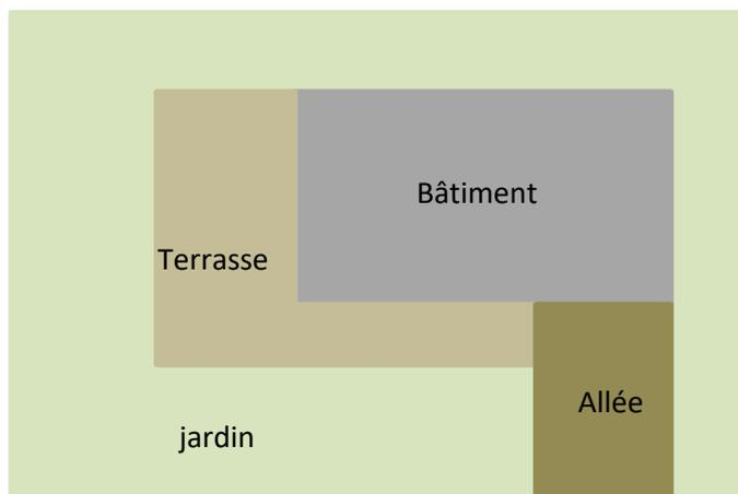
**Volume de stockage/ infiltration à prévoir sur la parcelle : 150 m<sup>2</sup> X 16 l = 2400 litres, soit 2,4 m<sup>3</sup>**
