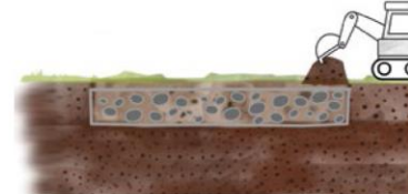
La franchée drainante
